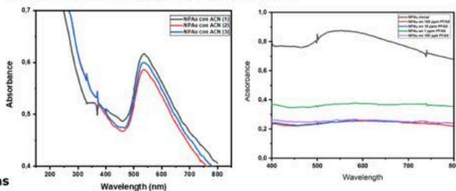
Figura 4. Mediciones del kit de colorimetría para PFAS en espectrofotometría UV-VIS y distintos rangos de concentración.
